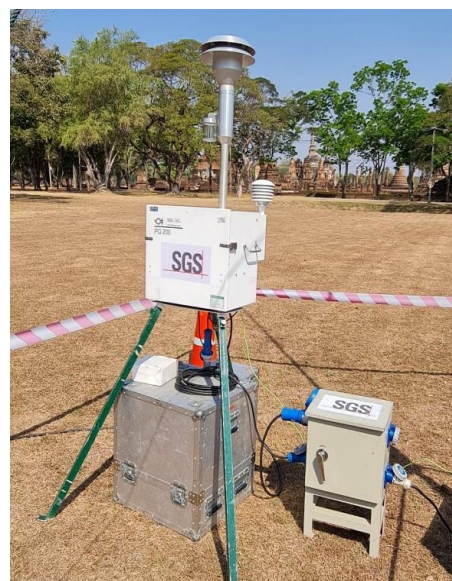
ภาพที่ 1 เครื่องมือตรวจวัดปริมาณฝุ่นละอองรวมเครื่อง High Volume Air Sampler (ซ้าย) และเครื่องตรวจวัดฝุ่นขนาด PM 2.5 (ขวา)
