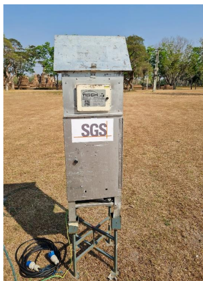
ภาพที่ 1 เครื่องมือตรวจวัดปริมาณฝุ่นละอองรวมเครื่อง High Volume Air Sampler (ซ้าย) และเครื่องตรวจวัดฝุ่นขนาด PM 2.5 (ขวา)
