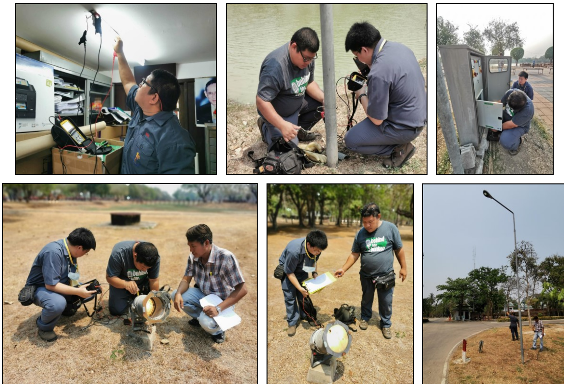
รูปที่ ก-1 การตรวจวัดการใช้พลังงานของหลอดไฟ
