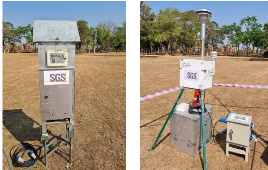
ภาพที่ 5.1 เครื่องมือตรวจวัดปริมาณฝุ่นละอองรวมเครื่อง High Volume Air Sampler (ซ้าย) และเครื่องตรวจวัดฝุ่นขนาด PM 2.5 (ขวา)
