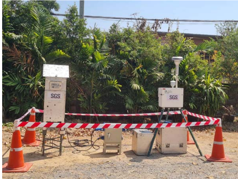
ภาพที่ 5.4 การตรวจวัดคุณภาพอากาศในบรรยากาศบริเวณชุมชนใกล้เคียงกับอุทยานประวัติศาสตร์สุโขทัย (UTM 47Q 576609E, 1881774N)
